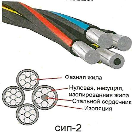
В зависимости от нагрузки участков, реконструкция ВЛ-0,4 кВ будет производится СИП2 сечением от 16 до 95 мм<sup>2</sup>.
